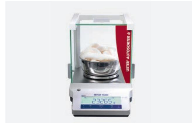
**Точное определение линейной плотности пряжи**
