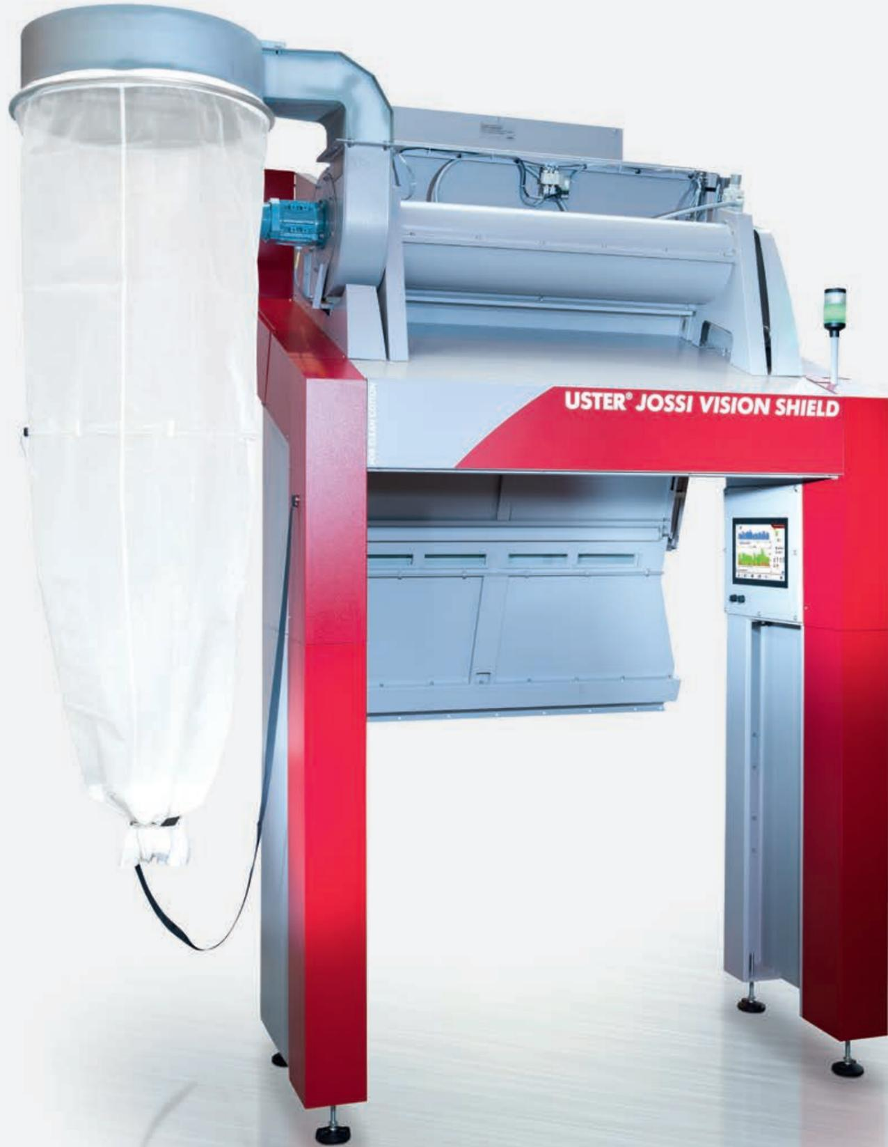
Uster Jossi Vision Shield 2异纤检测仪在较高生产速度下提供最佳检测效率。几乎没有有色或白色合成材料通过纤维清洁阶段。结合多种检测原理可确保原纤维不含不需要的物质：例如杂质、叶子、合成材料碎片、薄膜、废物、包装材料和地膜等。Uster Jossi Vision Shield 2异纤检测仪可以检测到所有东西，但只清除必须要清除的异物。这保证了优质原料的损失尽可能最低。
